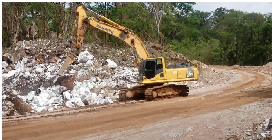
Figura 16. Conjunto Rompedor Hidraulico com Escavadeira Komatsu PC 350 LC
